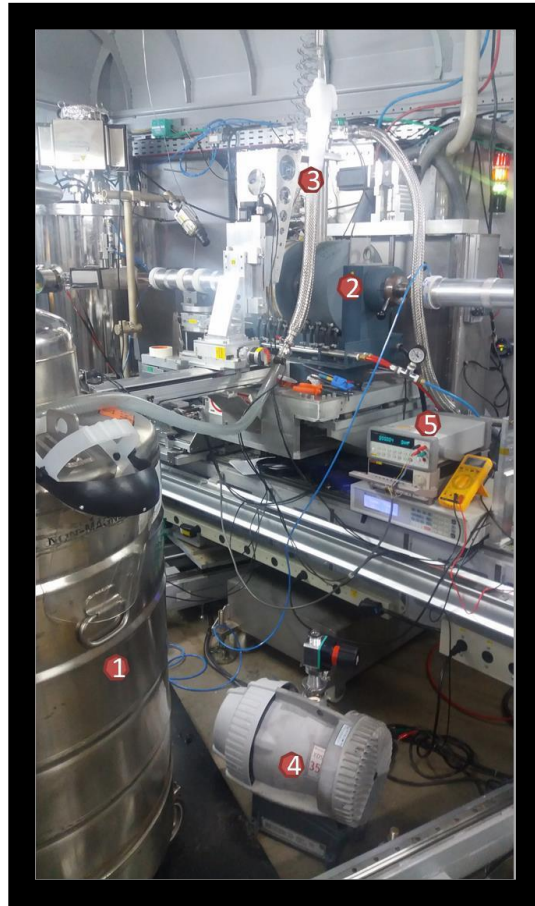
Figura 3.3. Instalação de XMCD na linha de luz DXAS (1) hélio Dewar (2) Bobina eletromagnética (3) Criostato (4) Bomba turbo-molecular (5) Dispositivos eletrônicos.
