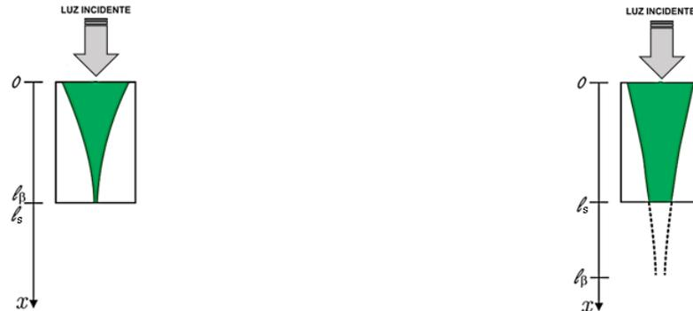
Figura 37 – Amostra absorvedora quanto à luz incidente  $l_\beta \approx l_s$ .      Figura 38 – Amostra transparente à luz incidente  $l_\beta \gg l_s$ .
