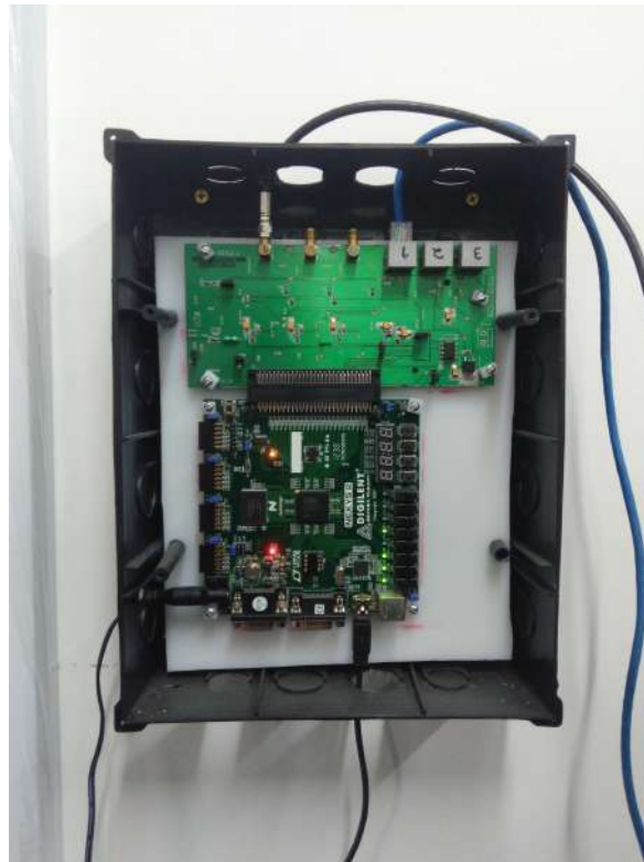
Figura 3.4: Sistema eletrônico de aquisição de dados do TD Caju composta pela placa digitalizadora (placa superior) e a FPGA Nexys2 (placa inferior).
