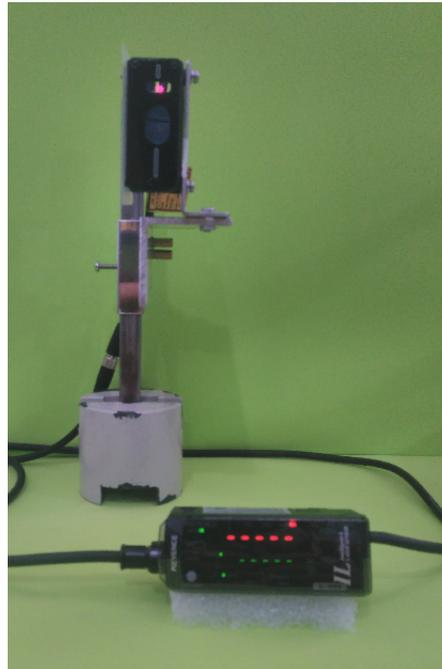
Figura 2.8 – Sensor óptico modelo Keyence IL-S025, empregado na aquisição de dados experimentais.
