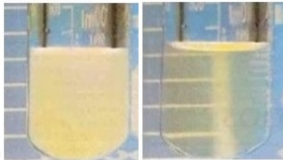
Figura 1.2: à esquerda à uma temperatura de 145^{\circ}\text{C} e 179^{\circ}\text{C} (aspecto leitoso fase líquida cristalina) e à direita é Benzenoato de Colesterila acima 179^{\circ}\text{C} (fase Líquida) [70].
